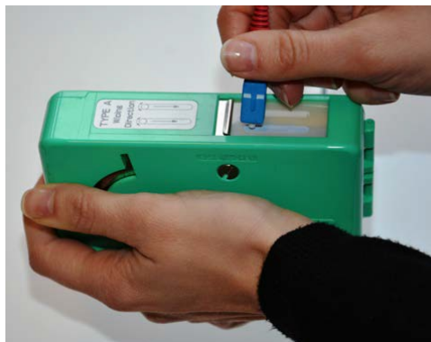
Rengöring av fiber med rengöringskasett
