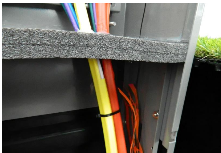
Exempel på korrekt slitsad kappa
