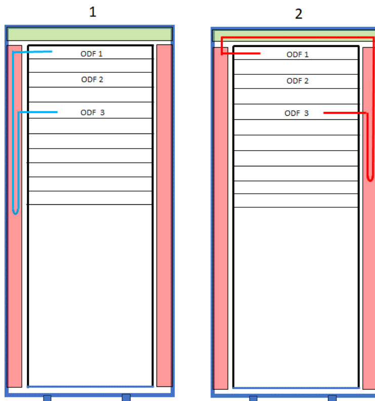
Exempel på korskoppling mellan ODF-enheter
