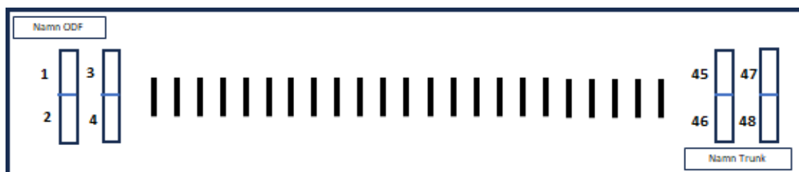
Exempel på kontaktnumrering i ODF-enhet.
